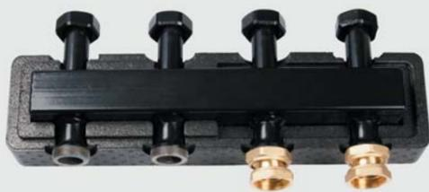
Rozdzielacz do podłączenia sprzęgła i grup, przyłącza GZ6/4 x GW6/4 (śrubunkowe pod płaską uszczelkę), w komplecie złączki oraz uchwyty montażowe.
