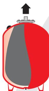
**Rozgrzana instalacja** – woda zwiększa swoją objętość i wypełnia membranę w znacznej jej części. Ważne jest, aby objętość naczynia była tak dobrana, żeby przejąć różnicę objętości pomiędzy wodą zimną a gorącą.
