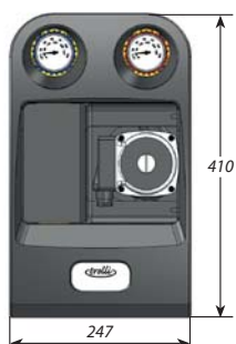
Rys. 39 Wymiary grup pompowych DN25
