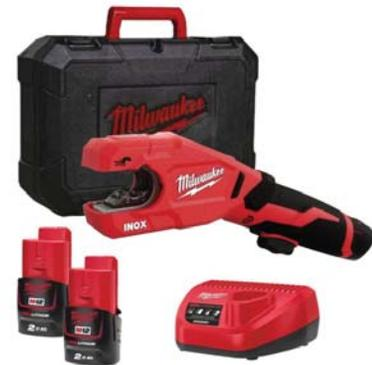
Wysokosprawny silnik Milwaukee 500 obr/min przecina 12 mm rurę miedzianą poniżej 3 sekund. Automatyczny mechanizm blokady cięcia z prześwitem do 37 mm. Automatyczna nastawialna szczeka, uchwyt slimline softgrip. Elastyczny system akumulatorów: współpracuje ze wszystkimi akumulatorami Milwaukee M12.
