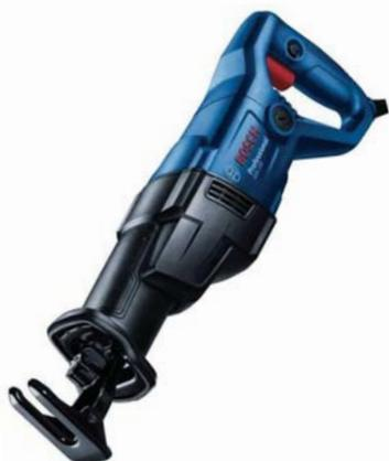
Jedna z najbardziej popularnych pił szablastych ważąca zaledwie 3,7 kg wyposażona w silnik dużej mocy 1200W pozwalający na pracę pod dużym obciążeniem. System wymiany brzeszczotów - BOSCH SDS, zużyty brzeszczot wymieniany jest bez dodatkowych narzędzi i przy użyciu jednej dłoni. Płynna, elektroniczna regulacja prędkości skokowej w zakresie od 0 do 3.000 obr./min. System tagodnego rozruchu oraz regulowany ogranicznik głębokości cięcia.
