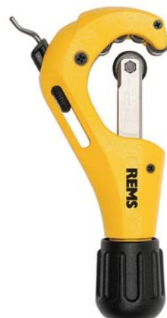
Wytrzymałe narzędzie wysokiej jakości do cięcia rur 3-42 mm dla grubości ścian do 4 mm. Długie prowadzenie wrzeciona i specjalnie hartowane rolki dociskowe zapewniają dokładne prowadzenie na rurze, lekkie przestawianie, lekkie i precyzyjne prostopadłe cięcie. Specjalnie hartowane kółko tnące z niezawodnej, ciągliwo-twardej stali nożowej zapewnia dużą trwałość. Ostrze wymienne.
