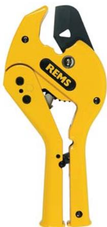
Prosta i jednocześnie wyspecjalizowana konstrukcja umożliwiająca czyste cięcie rur. Dwustronna podpora rury i dwustronne prowadzenie ostrza pozwalają na prostopadłe i nie wymagające gratowania cięcie. Zapadkowy posuw dźwigni zapewnia wysokie przełożenie siły nawet przy obsłudze jedną ręką. Wymienne, hartowane klinowe ostrze umożliwi cięcie też rur cienkościennych. Szybki ruch powrotny usprawnia pracę i pozwala zaoszczędzić czas. Stabilna konstrukcja wykonana z aluminium.
