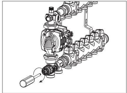
**Uwaga!!!** Regulacja zaworu może być wykonana tylko wtedy, gdy temperatura powrotu z pętli ogrzewania podłogowego będzie niższa niż temperatura wody zmieszanej, którą chcemy ustawić. W przeciwnym razie radzimy wyłączyć kocioł i poczekać do całkowitego schłodzenia systemu.
