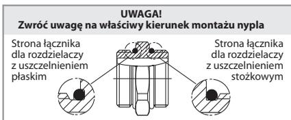
Podłączenie łączników do rozdzielacza
